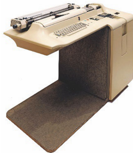
„P 203“, 1967, eine Erweiterung des Programmes „P 101“. Ein Minicomputer für das Büro. Design Mario Bellini.
